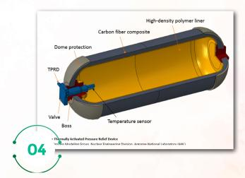
但氫在高壓的情況下,氫原 子會像一個非常小的錐子,進入 到金屬中,越來越多的氫原子進 入金屬中,氫脆的現象就非常容 易發生,所以用來儲氫的裝置要 用高強度的纖維材料去承受高壓 氫氣,還要對氫脆不敏感的材料 來提高安全性能,例如專門用於 航天級儲氫系統。
