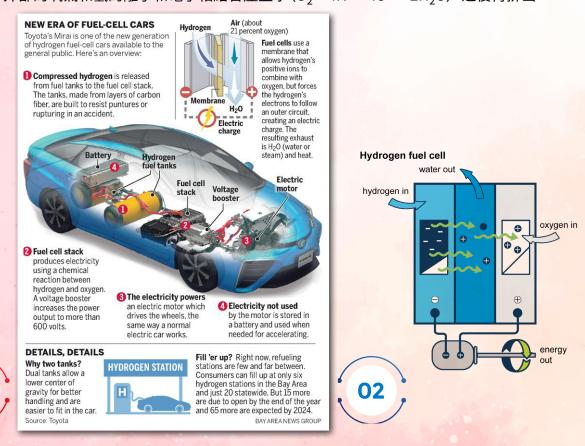
當然,在真正的氫能車上,其系統更加複雜。除了燃料電池堆,還需要搭配高壓儲氫罐(通常 壓力達700 bar)、動力控制單元、鋰電池緩衝系統,以及熱管理裝置來維持電池效率。我們就以豐 田的第二代氫燃料電池車Mirai為例,它的燃料電池有一個像三明治一樣,共有五層的結構。最上 和最下面的一層是由碳材料組成,這可以給整個電池一個支撐和串聯連接的作用,而最中間的一 層是一種特殊的塑膠膜,學名為「質子交換膜」(Proton Exchange Membrane, PEM),其厚度僅 15-30微米, 卻需具備高導離子性與機械強度, 目前杜邦公司的Nafion膜仍是市場主流。夾著最中 間那層的上下兩層是由鉑基材料製成的,這是為了加速氫氣的質子和電子的分解過程,把氫氣分 子變成兩個質子和兩個電子,但鉑金屬的稀缺性導致催化劑成本占燃料電池總成本40%以上,這 也是研究團隊積極開發鐵、鈷等替代材料的原因。而這個裝置則需要幾百個才能提供足夠的電壓 來驅動汽車行駛。
