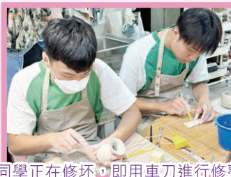
同學正在修坯，即用車刀進行修整
