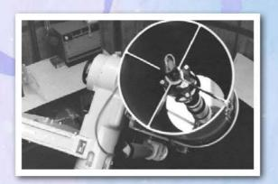
利用一塊雙曲面凸鏡(Convex hyperboloid)作為副鏡,在主鏡焦點前將光線聚集, 穿過主鏡一個圓孔而聚焦在主鏡之後。因 為經過一次反射,所以鏡筒可以縮短,但視 場較窄,像散較牛頓式嚴重,同時有少許場 曲(Curvature of field)。
