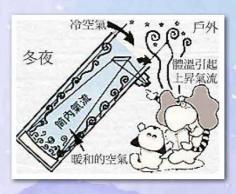
因為鏡筒不可能密封,所以主鏡很易受煙塵影響, 故難於保養,同時受氣溫與鏡筒內氣流的影響較 大,搬運時又很易移動了主鏡與副鏡的位置,而校 正光軸亦相當繁複,帶起來不甚方便。此外副鏡座 的衍射作用會使較光恒星的星像出現十字或星形 的衍射紋,亦使影像反差降低。
